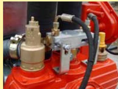
Domventil mit 2-Kugelsystem u. Schnellverschluss
