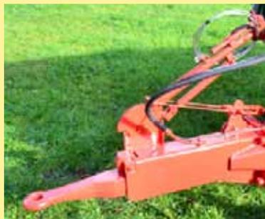
Zentralschmierung mit Schmierleiste (auch mit autom. Zentralschmierung ausrüstbar)
