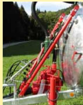
**Einachs-Vakuumfass** für Oben- und Untenanhängung mit hydr. Deichselverstellung bzw. hydr. Deichselfederung mit Gasdruckdämpfer
