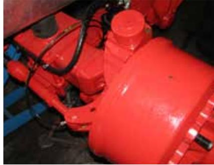
Hydr. Deichselfederung mit Gasdruckdämpfer bzw. hydr. Talausbringung
