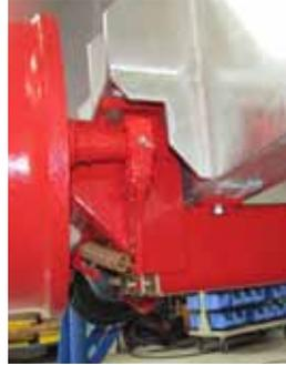
Gefedertes Boogieaggregat mit hydraulischer Nachlauf- oder Zwanglenkung und Zentralschmierung
