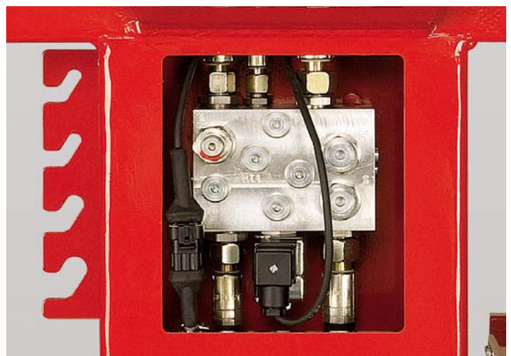
Steuerblock mit Proportionaltechnik für die stufenlose Regelung der Spindeldrehzahl
