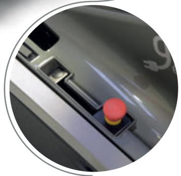
**NOTAUS-SCHALTER:** Durch Drücken des Schalters stoppen im Notfall sofort alle Maschinenfunktionen.
