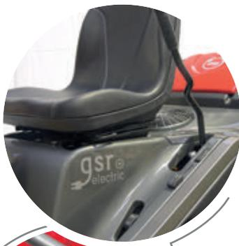
**HEBEL FÜR MÄHWERKSAUSHUB UND SCHALTER FÜR DIE SCHNITTHÖHENVERSTELLUNG UND VERTIKALE WARTUNGSPPOSITION**
