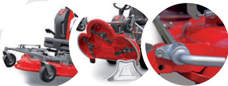
Das Mähwerk des GSR+ electric kann sehr einfach von Mulchen auf Heckauswurf umgestellt werden, dazu muss nur ein federbelasteter Hebel auf der rechten Seite des Mähdecks entriegelt werden. Anschließend kann der Aluminium-Verschussdeckel unter dem Mähwerk entnommen werden.
