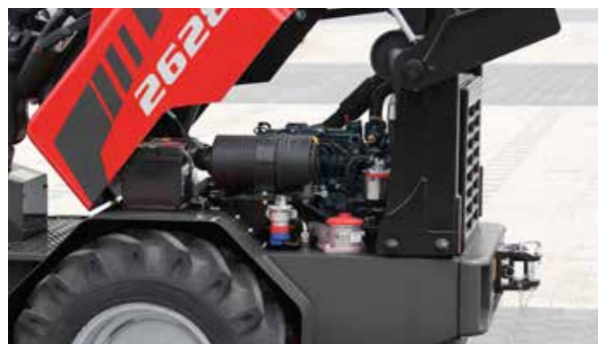
Le capot moteur s'ouvre vers l'avant. Tous les points de service sont facilement accessibles, des deux côtés de la machine.
