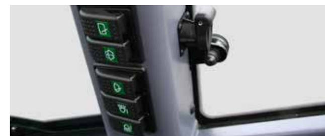
Commande centralisée groupée - Prise 12v
