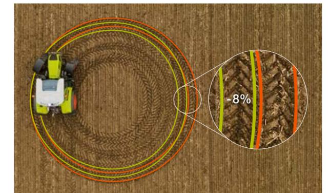
— Mit lenkwinkelabhängiger Allradautomatik für bis zu 8% kleinere Wendekreise
