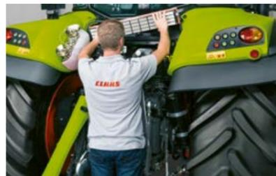
Einfache Erreichbarkeit des Kabinenluftfilters hinter der Kabine.
