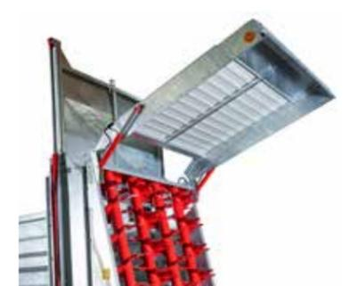
**Streuerwerkschutz hydraulisch hochklappbar**
