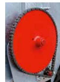
Ketten-übersetzung 1:8 mit Danfoss Qualitäts-Ölmotor (Modelle SM 350/380/450)
