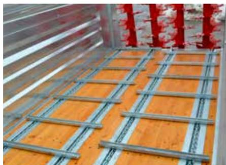
**Massiver Kratzboden** mit 4 Qualitätsketten G80 (höchster Gütegrad) verzinkt 10x31 Bruchkraft 12 Tonnen pro Strang. Hintere Antriebswelle mit Abdeckung.
