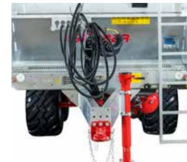
**Kräftige Flanschzugöse D40** 2500 kg, Kurbelstützrad mit Getriebe, Aufstiegsleiter serienmässig
