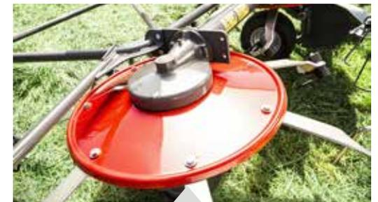
Große Kreisel bedeuten hohe Zinkengeschwindigkeit bei niedriger Drehzahl.
