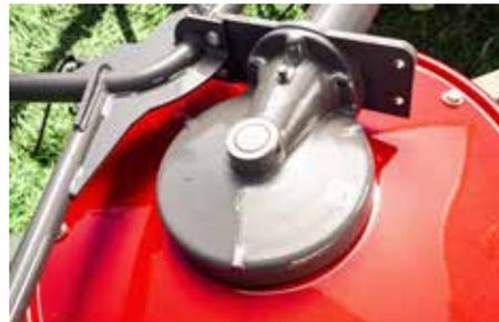
Geringe Betriebskosten und unkomplizierte Wartung dank der wartungsfreien Kreuzgelenke, den gut zugänglichen Gelenk-Schmiernippeln und dem Getriebe mit Ölfüllung.
