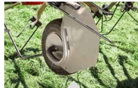
Effektiver Wickelschutz, damit sich das Erntegut nicht um die Radachse legt.
