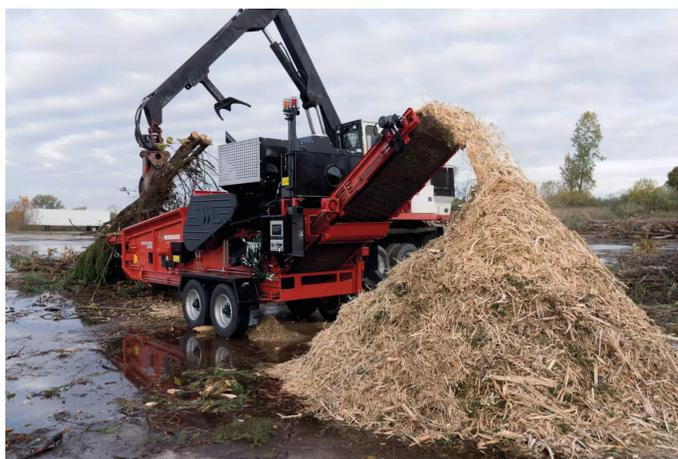
La hauteur de transbordement standard du convoyeur est de environ 2,8 mètres.
