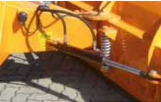
Hydraulische Schrägstellung (optional)
