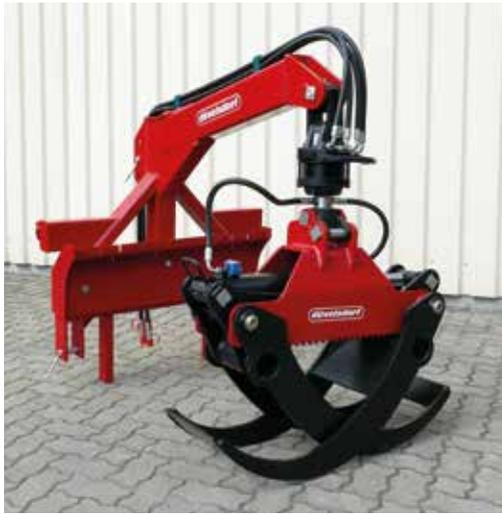
Die Forstzange mit Rotator eignet sich zum Stapeln und Rücken von Holzstämmen. Der Endlosrotator mit einer Traglast von 4,5 t und der Greifer mit 1560 mm Öffnungsweite ermöglichen ein komfortables Arbeiten. Der Anbau kann sowohl mit EURO Aufnahme am Frontlader erfolgen, als auch in der Dreipunkt mit KAT 2 Aufnahme.
