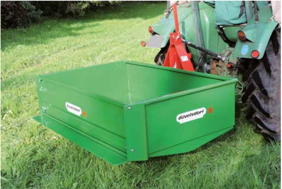
Ein praktischer Heckcontainer für den 3-Punkt-Anbau mit besonders robuster Verarbeitung mit mechanischer Kippvorrichtung.
