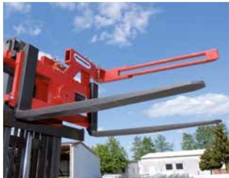
**Um das Kistendrehgerät in der EURO-Aufnahme zu nutzen, kann das FEM II mit dem Palettengabelträgerbock kombiniert werden.**
