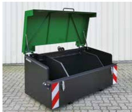
Weiterhin ist die Transportbox HD mit einer Begrenzungsleuchte, Anbauplatten für Lenkrollen sowie eine Einfahröffnung für Gabelstapler ausgestattet. Durch die Dreipunkt-Aufnahme (KAT 1 und KAT 2) lässt sich die Transportbox schnell und sicher am Schlepper montieren. Die Traglast beträgt 1000 kg.
