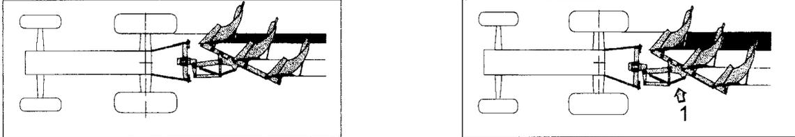
Damit der erste Pflugkörper mit der richtigen Schnittbreite pflügt, wird die hintere Spindel (1) betätigt.
