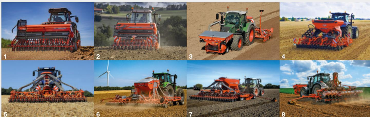
1. Anbaumaschinen - 2. Integrierte Maschinen - 3. Mit Fronttank - 4. Integrierte pneumatische Maschinen - 5. Klappbare pneumatische Drillmaschinen - 6. Zinkensämschienen - 7. Gezogene Mulchsämschienen - 8. Einzelkornsämschienen
