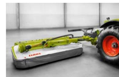
Mit hydraulisch steuerbaren Auslegern werden je nach Frontmähdwerk zwischen 9,40 m und 10,70 m Arbeitsbreite erreicht.
