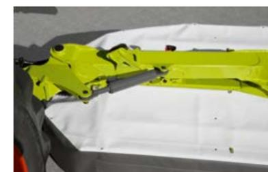
Schutz durch hydraulische Nonstop-Anfahrtsicherung im Fall einer Kollision: Die Mäheinheit schwenkt aus und positioniert sich selbstständig in die Ausgangsposition.
