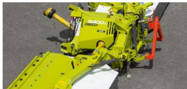
Schutz durch hydraulische Nonstop-Anfahrtsicherung im Fall einer Kollision: Mäheinheit schwenkt aus und positioniert sich selbstständig in die Ausgangsposition.
