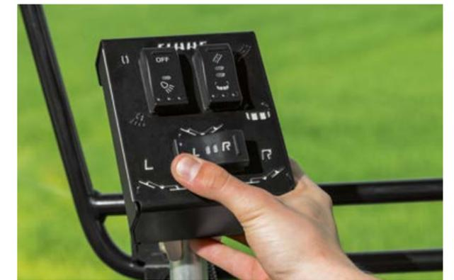
Für das DISCO 1100 TREND gibt es eine praktische Bedieneinheit für den Einzelaushub, die Klappung in Transportstellung und optional das Ein- und Ausschalten der Arbeitsscheinwerfer.
