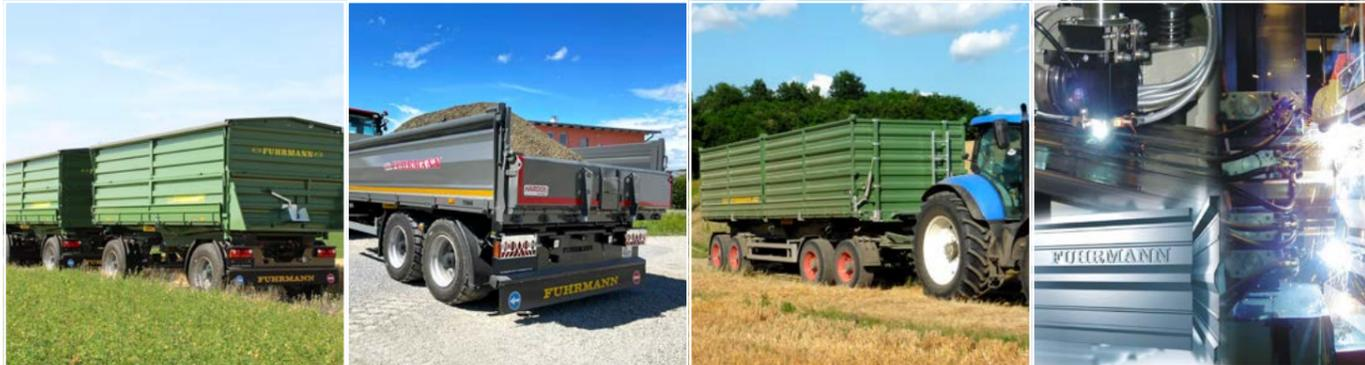
Durch diese Konstruktionsmerkmale bieten FUHRMANN-Kipper in Verbindung mit einer optimierten Fahrzeugrahmenweite, stabiler Blattfederung und breiter Fahrzeugspur ausreichende Reserven im schweren Praxiseinsatz und hohe Standsicherheit im unebenen bzw. unbefestigten Gelände. Das zentrale Kipprohr mit den Kugelkipplagern leitet die Kraft optimal in den Hauptrahmen ein, Kippersteckbolzen mit der Überkreuzstecksicherung verhindern schwere Rahmenschäden durch falsches Einstecken der Bolzen.
