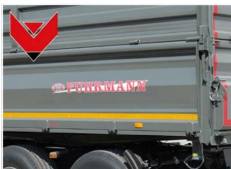
HARDOX - Stahlbordwände
