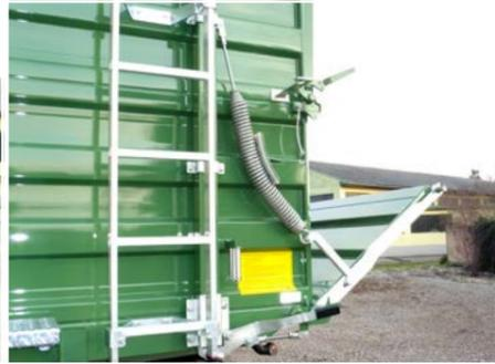
Bordwandhebefedernsystem für 800 mm Bordwände (teilabgeklappt)
