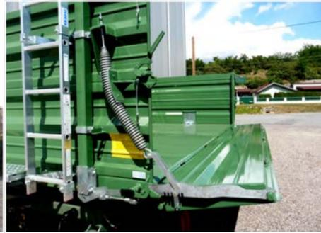
Komfort-Bordwandhebefedernsystem für 600 mm Bordwände (abgeklappt)
