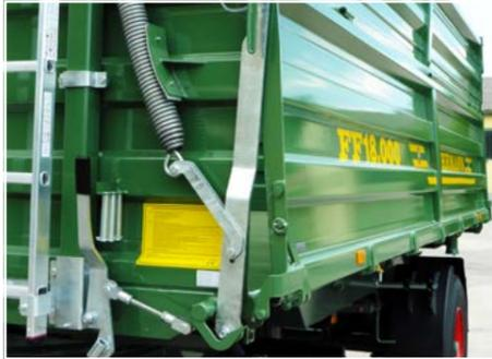
Bordwandhebefedernsystem für 800 mm Bordwände (Pendelbetrieb)
