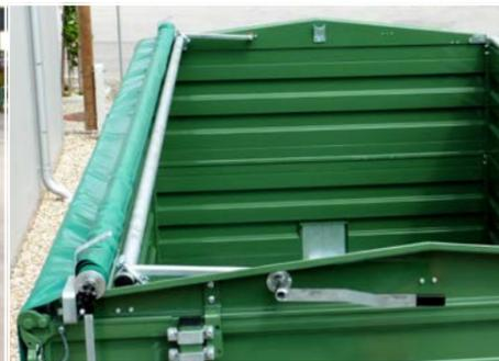
Klappbares Mittelrohr für Planenaufbau
