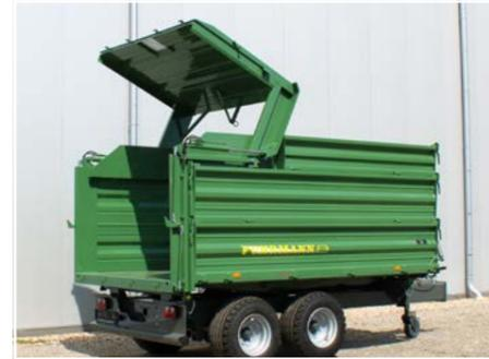
Hydraulische Rückwandöffnung mit zwei doppelwirkenden Zylindern
