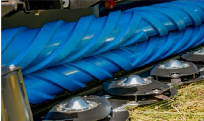
Der **Aufbereitungsdruck ist über eine Hebelsteuerung einstellbar**, die mit Torsionsstäben verbunden ist, die den Rollenabstand von 0 bis 40 mm einstellen. In der letztgenannten Position läuft das gemähte Viehfutter zwischen den Rollen durch, ohne aufbereitet zu werden.
