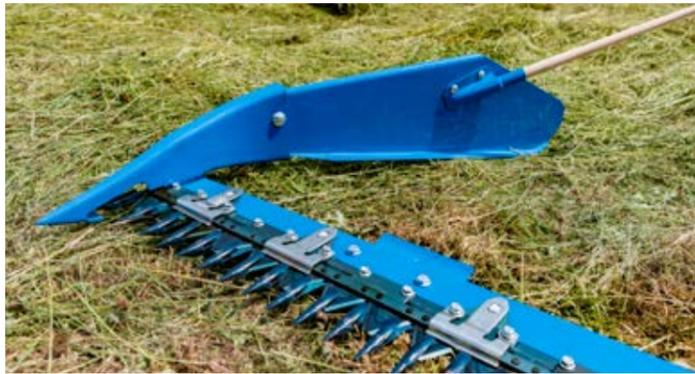
Die Bodenbelastungseinstellung des Schneidwerks ist federbelastet, so dass der Mähbalken der Bodenkontur perfekt folgen kann, um einen sauberen Schnitt und ein Viehfutter zu erhalten, das nicht durch Erde oder Steine verunreinigt ist.
