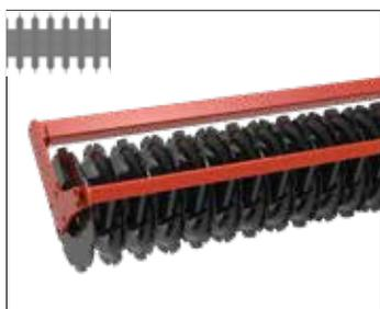
Rouleau lourd qui assure un bon travail en conditions humides et pierreuses. Son profil en V limite le ruissellement et améliore les infiltrations d'eau dans l'inter-rang. Il présente une forte capacité de rappui et de consolidation.
