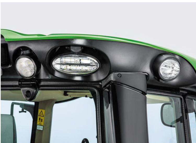
Fast schon Hellsehen: Unsere werkseitig installierten Beleuchtungspakete ermöglichen ein breites, konzentriertes Lichtfeld rund um Ihren 6M Traktor. Für anspruchsvollere Beleuchtungsanforderungen können Sie LED-Beleuchtungspakete auswählen. Diese verbrauchen weniger Strom, liefern helleres, tageslichtähnliches Licht und sind langlebiger.
