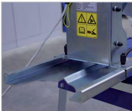
Le plateau tournant est réglé. Grâce à un plateau tournant flexible, même les couteaux à lames courbes, avec petits ou grands rayons, peuvent être parfaitement et efficacement aiguisés.
