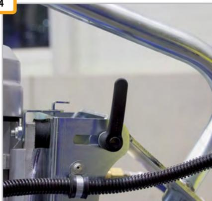
L'inclinaison de l'unité d'affûtage doit être réglée. Le réglage en continu de l'angle de la meule vous assure un affûtage idéal.
