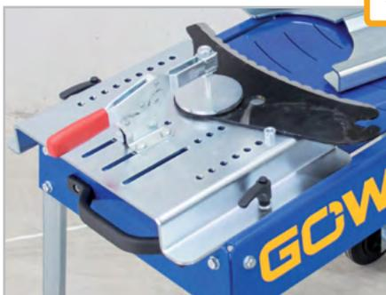
Das Messer muss positioniert werden. Die leicht verstellbaren Anschlagsschrauben auf dem Verstellblech ermöglichen dabei die optimale Position zu finden.
