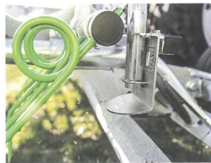
Die Grassaat wird über zehn Prallteller vor und in das Striegelfeld geblasen.
