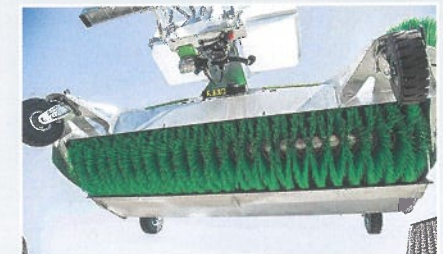
Der Walzenbesen besteht aus ineinandergesteckten Elementen. Der Hydromotor ist in der Achse verbaut.
