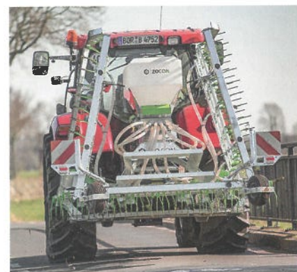
Auf der Straße klappt der Greenkeeper kompakt. Er wiegt in dieser Ausstattung 1060 kg.
