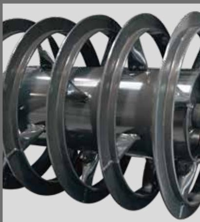
**T-Ring** : rouleau léger, agressif sur les mottes et les pailles, maintient une bonne rugosité au sol. Idéal en terres limoneuses.
