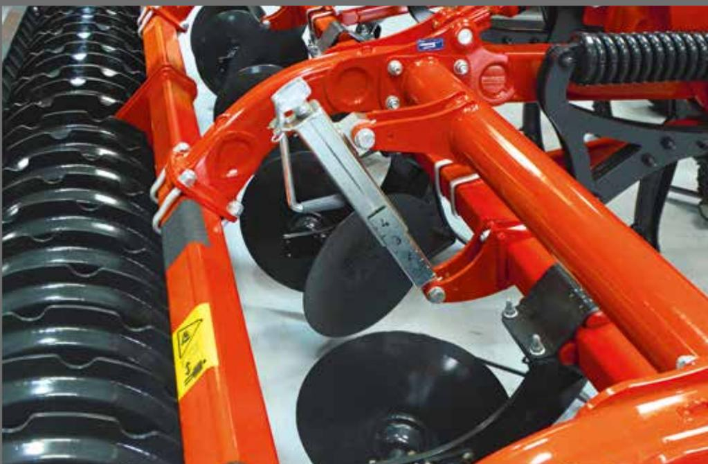
Le réglage des organes de nivellement est centralisé par une manivelle. Les éléments de bordure réglables latéralement permettent des raccords parfaits.
