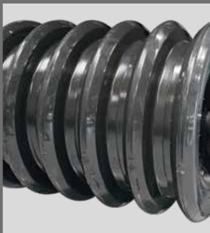
**Packliner** : rouleau à bandage caoutchouc, idéal en terres légères ou pour garantir une surface maximale de rappui au sol.
