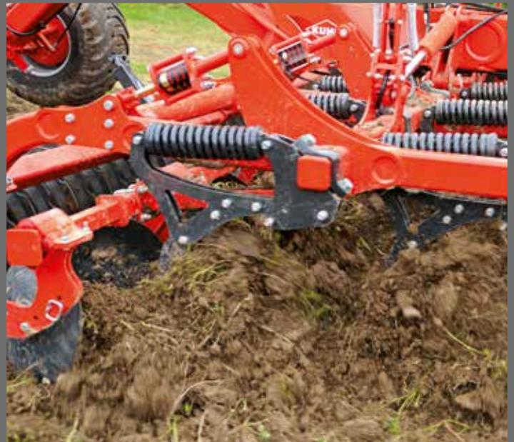
Grâce à son déflecteur vrillé, la dent assure une répartition optimale de la terre fine, de la paille et des mottes, tout en limitant le besoin de puissance.
