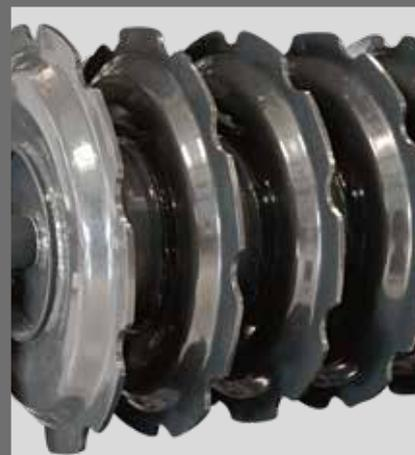
**HD-Liner 600** : le rouleau lourd, à forte capacité de rappui. Le profil V répartit les forces verticalement et à l'oblique, pour un rappui en profondeur sur toute la largeur du rouleau.
