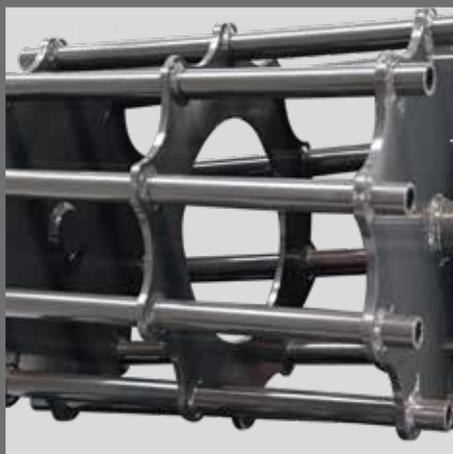
**Tube** : rouleau économique et léger, assure un rappuyage correct ainsi qu'un bon maintien de la machine sur des terres légères à moyennes.
