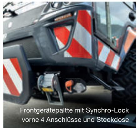
Frontgerätepalte mit Syncro-Lock vorne 4 Anschlüsse und Steckdose
