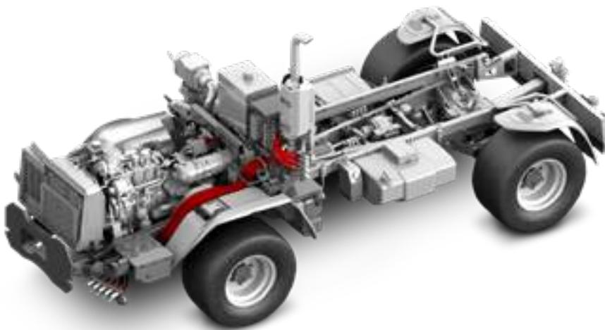
**Arbeitshydraulik mit Verstellpumpe**
