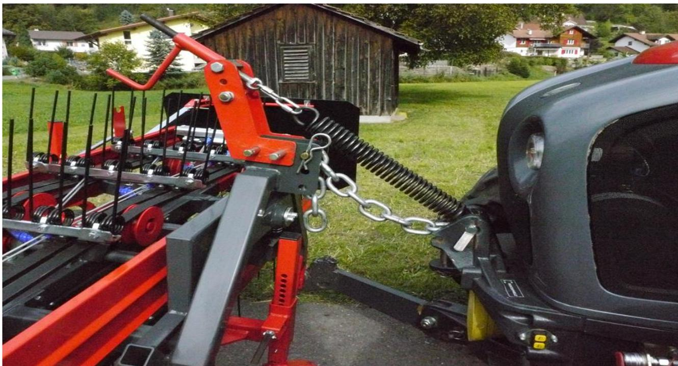
Für optimale Boden Anpassung können 1 oder 2 Stützräder montiert werden. Die Pendelung ist über den Drehbolzen gewährleistet.
