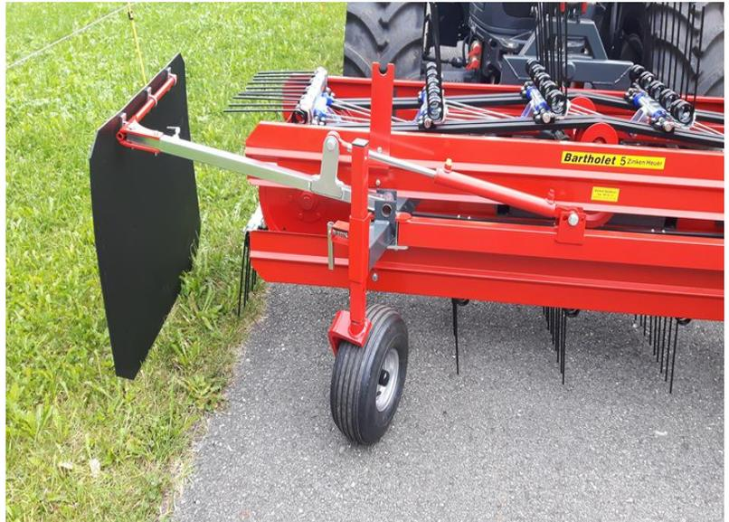
**Bei allen Typen kann eine hydraulische Schwadfahne montiert werden.**
