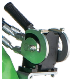
Multiconnecteur sur chargeur A34366
