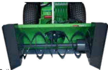
Fraise à neige équipée d'élargisseurs de côté
