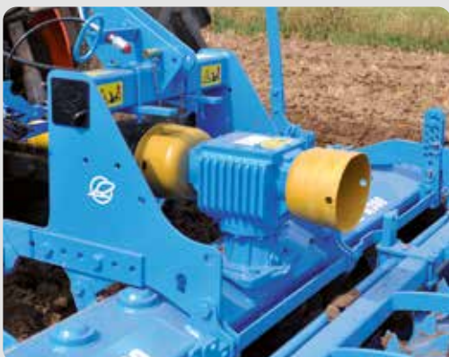
Einfache Kraftübertragung durch das Wechselradgetriebe
