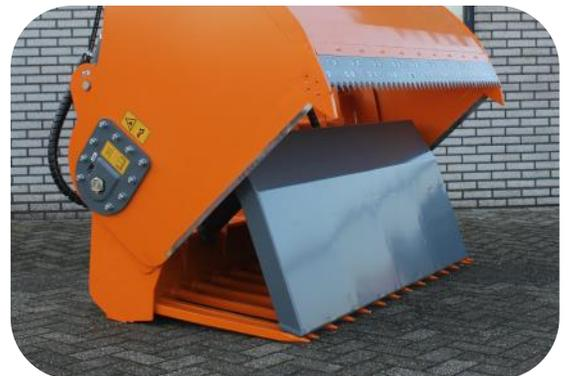
Die hydraulische Abschiebeeinheit kann mit einem Einlegeschaufeln ausgestattet werden. Dieser kombiniert die Vorteile einer geschlossenen Schaufel und einer Zinkenschaufel. Der Einlegeschaufel ist einfach zu installieren, indem er an der Zange eingehängt und die Zange eingezogen wird.
