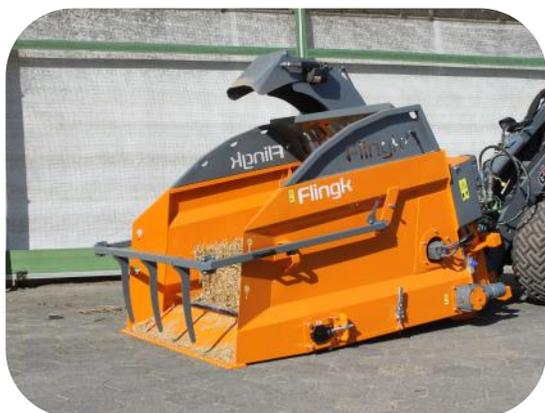
Das SHC Einstreugerät von Flingk ist ein kompaktes und leichtes Verteilgerät für Stroh. Die Maschine ist speziell für den Einsatz an kleinen Hof- und Teleskopladern konzipiert. Der Typ SHC verfügt über ein Wurfgebläse mit Auswurf, über den die Wurfweite und damit die Einstreutiefe von der Fahrzeugkabine aus reguliert werden kann. Der Typ SHC R hat einen um 275° drehbaren Auswurf für schnelles und flexibles Arbeiten.
