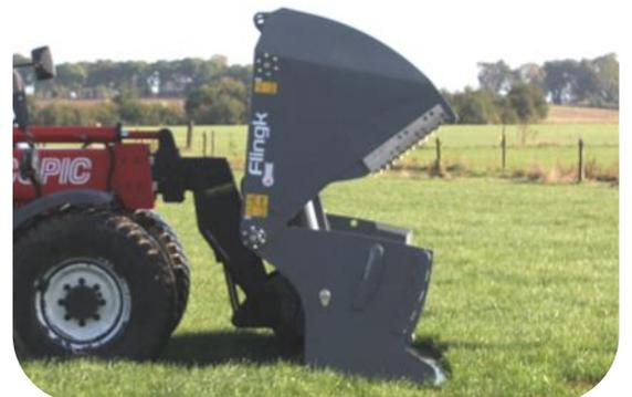
Da die Silozange mit großer Höhe und geringer Tiefe greift, wird die Silowand häufig erneuert und kann immer ein großes Volumen mitgenommen werden. Aufgrund der dünnen Schichten ist es möglich, dosiert in den Mischwagen zu entladen.
