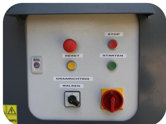
Einfache intuitive Bedienung. Beim Einschalten schaltet sich zuerst der Schneidschrank und einige Sekunden später die Walzen ein, damit keine Spannungsspitzen entstehen. Beim Ausschalten schalten zuerst die Walzen ab, damit der Schneidkaste entleert wird. Die Motoren sind überlastgeschützt.
