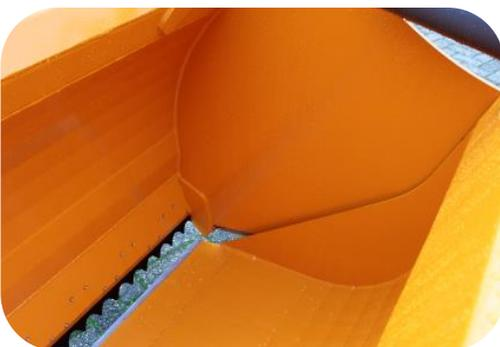
**2** Der Körper der Silozange ist an der Innenseite abgerundet. Dadurch wird sichergestellt, dass das Raufutter leicht entladen werden kann und nicht in den Ecken hängen bleibt. Dies verringert den Verschleiß der Schaufel oder des Teleskopladers und verbessert den Fahrerkomfort.
