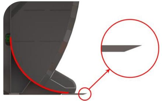
Die selbstschärfenden Messer haben feine Zähne und sind aus hochlegiertem Werkzeugstahl gefertigt. Hierdurch bleiben die Klingen lange Zeit scharf und es wird weniger Kraftaufwand beim Schneiden benötigt. Es entsteht eine gerade Silowand.
