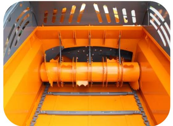
Zwischen Dosierwalze und Turbine wird das Stroh aufgelockert, ohne es zu zerkleinern. Anschließend wird das Stroh von der Turbine angesaugt und weggeblasen. Sowohl kurzes als auch langes Stroh wird nicht zerkleinert, das Stroh wird geknickt und die Kapillaren werden an möglichst vielen Stellen geöffnet. Dadurch bleibt die Struktur erhalten, die Strohschicht bleibt länger erhalten und muss seltener ausgemistet werden.
