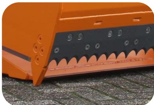
④ Die vorderen Messer sind aus verschleißfestem, gehärtetem Stahl gefertigt und haben feine Zähne. Dies gewährleistet einen sauberen Schnitt. Dadurch bleibt die Silowand länger frisch und der Kraftaufwand für den Silozange ist geringer. Die Klingen sind verschraubt und können leicht ausgetauscht werden.
