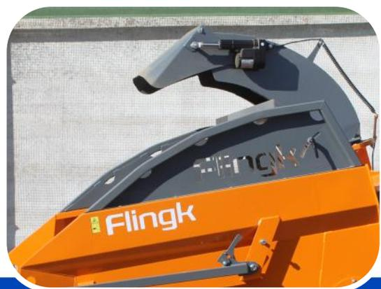
Das Wurfrad ist mit aufgeschraubten Wurfblättern ausgestattet. Die Wurfblätter sind so geformt, dass sie das Stroh so effizient wie möglich weit werfen, dabei aber so wenig Kraft wie möglich benötigen. Das spart Kraftstoff und reduziert den Staub. Die Maschine ist wartungsarm, da das Wurfrad direkt auf dem Hydraulikmotor montiert ist.
