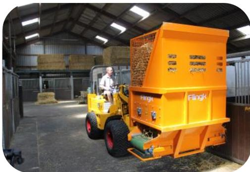
Mit dem für die kleine Lader gebauten SVV 1000 kann ein dritte bis halber Ballen von 2500x1200x900 mm verteilt werden. Hier ein Bild mit 1800x700 Förderband, um links und rechts auf bis zu 2,5 bis 3 Meter ein zu Streuen. Dies wird von der Außenseite der Maschine mit dem Förderband in einer Höhe von 1,8 m gemessen.
