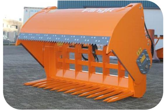
In Kombination mit dem Zinkenboden kann ein hydraulischer Abschieber gewählt werden. Dadurch entfällt oder verringert sich die Notwendigkeit, das Raufutter abzuladen. Dies ist ideal, wenn ein Traktor oder eine Schaufel eine begrenzte Hubhöhe hat. Für den hydraulischen Abschiebemechanismus ist eine zusätzliche Hydraulikfunktion erforderlich.
