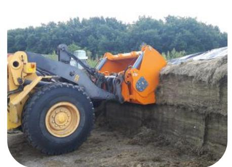
Die Standard-Silozangen der Typen KHSII, KHMII, KHLII und KHVII sind mit einem geschlossenen Kasten ausgestattet. Dies hat den Vorteil, dass weniger verschüttet wird. Außerdem können lose Produkte leicht verladen werden. Die Schaufel ist mit scharf gefrästen Hardox-Messern und Hardox-Verschleißstreifen für eine lange Lebensdauer ausgestattet. Da die abgeschrägte Kante der Klinge auf der Unterseite liegt, ist die Klinge weniger anfällig und bleibt lange Zeit scharf.
