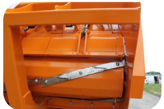
Die Schneidwalze schneidet über die gesamte Breite der Maschine, so dass eine hohe Kapazität erreicht werden kann.
