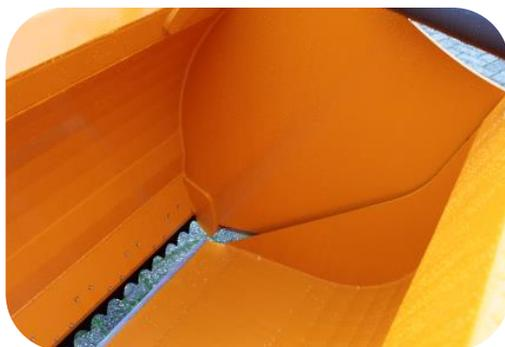
**2** Der Körper der Silozange ist an der Innenseite abgerundet. Dadurch wird sichergestellt, dass das Raufutter leicht entladen werden kann und nicht in den Ecken hängen bleibt. Dies verringert den Verschleiß der Schaufel oder des Teleskopladers und verbessert den Fahrerkomfort.
