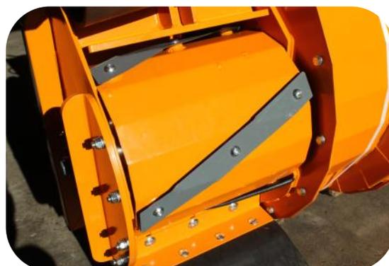
Der Behälter für den Sand und anderen Schmutz befindet sich an der Unterseite der Maschine. Durch Kippen der Maschine wird diese geleert.
