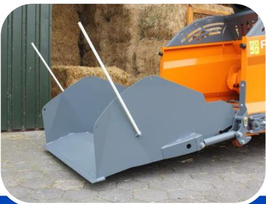
Der Typ SH 2500 R ist mit einer hydraulischen Ladeklappe ausgestattet. Diese erleichtert das Laden des Strohballens und minimiert das Verschütten von Stroh. Wenn die Klappe ganz eingefahren ist, ist die Maschine kompakt und lässt sich leichter manövrieren.
