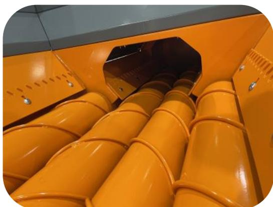
Die Spiralwalzen reinigen die Rüben und führen sie dem Schneidwerk zu. Der letzte Abschnitt der Rüben geht über die Walzen durch einen "Tunnel", hier werden sie zusätzlich gereinigt, bevor sie geschnitten werden. Sand und anderer Schmutz fällt an den Walzen vorbei auf den Boden unter der Maschine.
