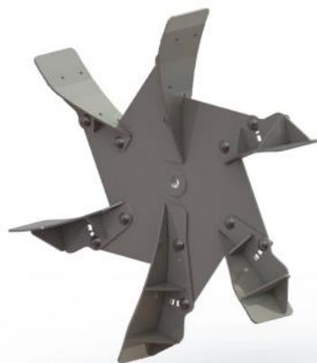
Das Wurfrad ist mit aufgeschraubten Wurfblättern ausgestattet. Die Wurfblätter sind so geformt, dass sie das Stroh so effizient wie möglich weit werfen, dabei aber so wenig Kraft wie möglich benötigen. Das spart Kraftstoff und reduziert den Staub. Die Maschine ist wartungsarm, da das Wurfrad direkt auf dem Hydraulikmotor montiert ist.
