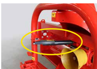
L'amortisseur hydraulique pour la souplesse des mouvements
