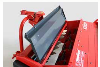
Ouverture de la machine pour entretien ou nettoyage
