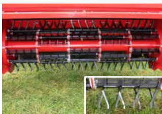
Rotor à fléaux en X réparti sur 8 rangées pendulaires
