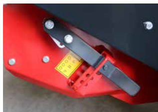
Le contre-râteau permet de régler le facteur de conditionnement
