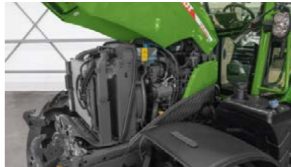
Der Motorraum ist zur Kontrolle und Wartung sehr einfach zugänglich, auch mit Frontladerbauteilen. Die Haube mit zwei separaten Seitenteilen ist komfortabel zu öffnen.
