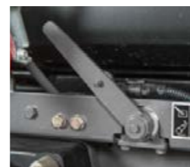
Verhindert Schäden an angehängten Geräten und Fehlbedienung: die Fixierung der Unterlenker über den Absperrrahm.
