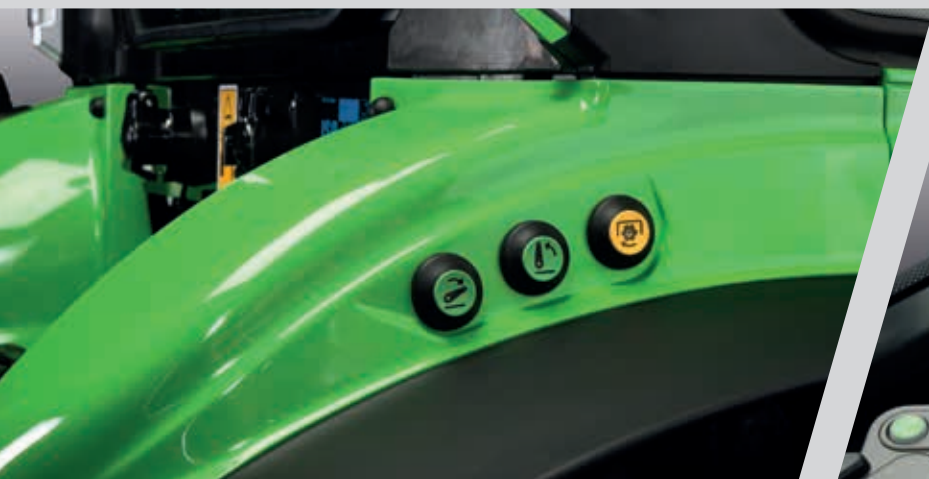
> Boutons externes de prise de force et de relevage arrière sur les ailes gauche et droite.
