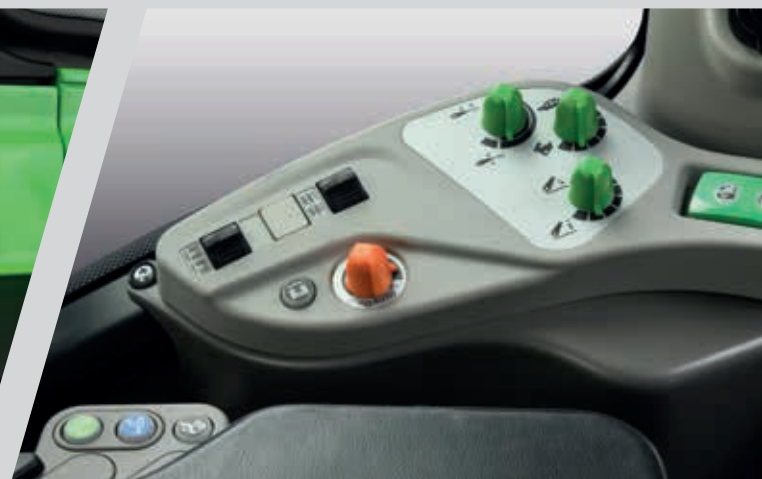
> Le conducteur peut choisir entre le mode de gestion du moteur « Eco » et « Power », pour une puissance maximale.
