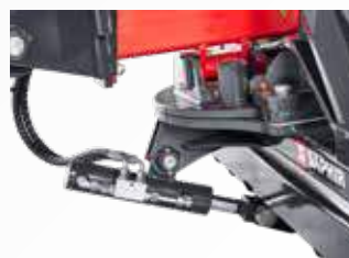
Optionale hydr. Vertikaleinstellung der Schürfleiste +/- 25°
