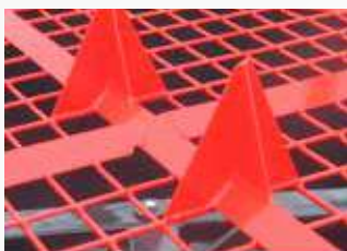
2 Aufreißerspitzen zum Öffnen von Säcken.
