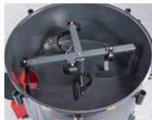
Vier gefederte und nachstellbare Mischscharre für die zügige Herstellung einer homogenen Mischung.
