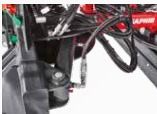
Optionale hydr. Seitenverstellung links / rechts je 800 mm
