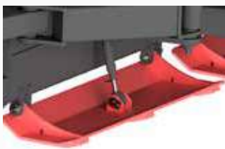
Optionaler Schleppkufensatz für eine leichtere Führung des Schildes auf dem Silostock
