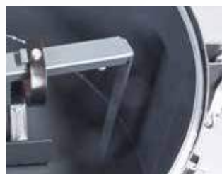
Nachstellbarer Seitenwandabstreifer zur restlosen Entleerung des Mischbehälters.
