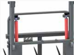
Gute Durchsicht durch zwei außen angebrachte Hubzylinder
